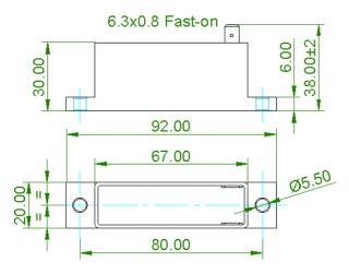
Fig. 1: Single RC module
