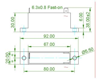
Fig. 2: Dual RC module
